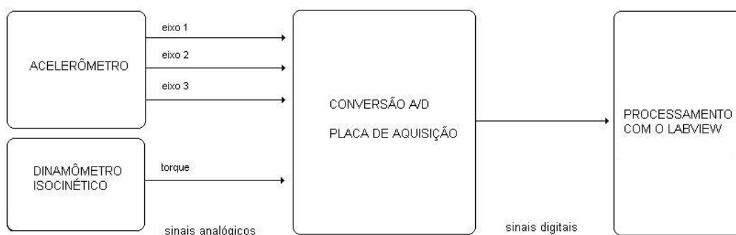
FIGURA 26 - Diagrama de blocos da aquisição dos sinais de MMG e de torque.
