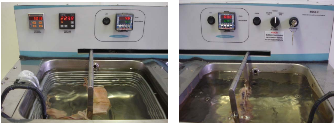
Figura 5 - 5.000 ciclos em temperaturas de \pm 6^{\circ}\text{C} e \pm 60^{\circ}\text{C} .
