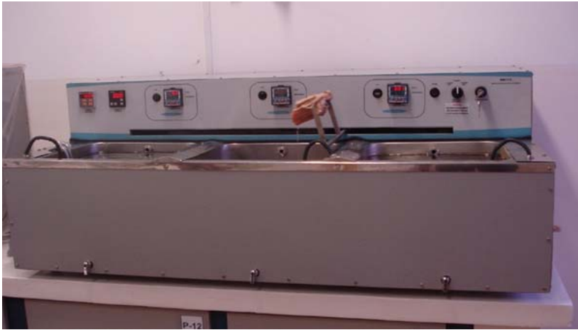
Figura 4 – Máquina de termociclagem, modelo MSCT-3 (São Carlos SP, Brasil)
