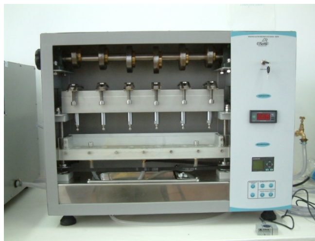
Figura 6 - Máquina eletro-mecânica de fadiga onde foi realizado 1.000.000 de ciclos a 40N. (ElQuip, São Carlos, SP, Brasil)
