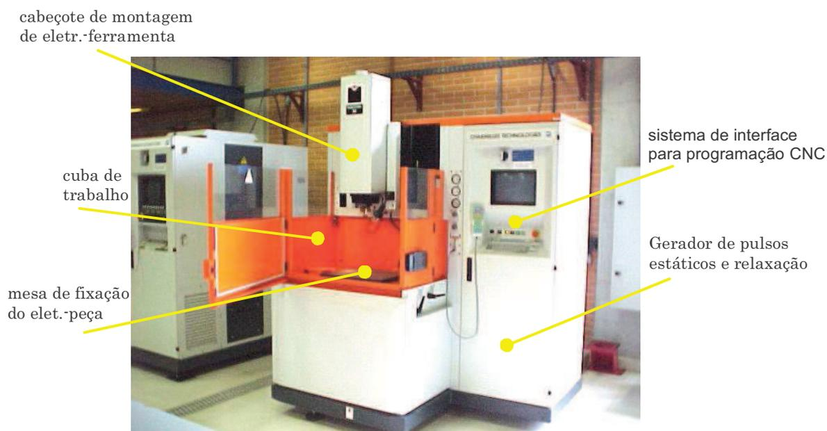
Figura 1.1 - Máquina Roboform 30 CNC.
