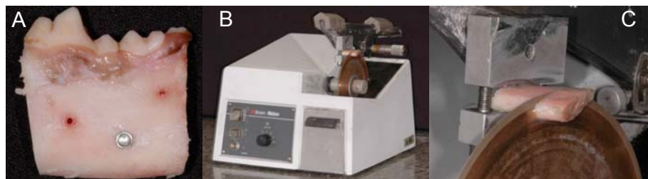
Figura 14. A , Bloco ósseo seccionado contendo o local de inserção do par de mini-implantes, o mini-implante que se encontra na foto faz parte de outra pesquisa; B,C , Bloco ósseo sendo seccionado na cortadeira metalográfica com disco diamantado rotatório.
