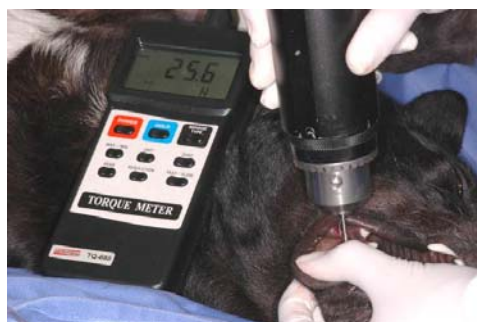
Figura 9. Medição do torque máximo de inserção com o torquímetro digital TQ-680 da marca IMPAC®.
