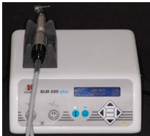
Figura 7. Motor elétrico Driller® BLM 600 PLUS e contra-ângulo de redução 16:1 Microdent®.
