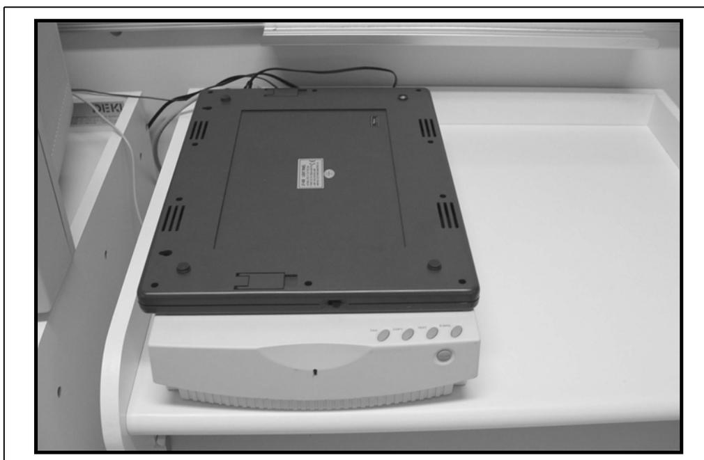
FIGURA 9 - NEGATOSCÓPIO POSICIONADO SOBRE O SCANNER
