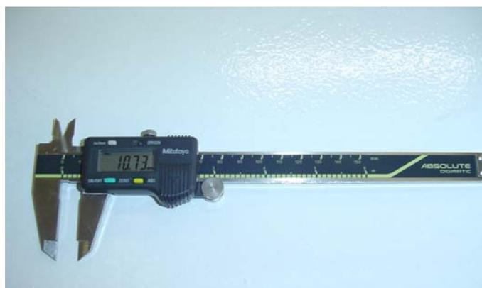
FIGURA 5 - PAQUÍMETRO DIGITAL
