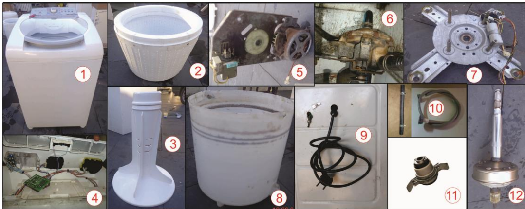
Figura 34 - Componentes da máquina de lavar roupas
