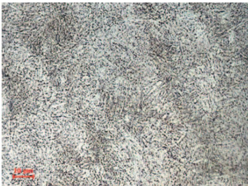
Figura 24: Microestrutura do núcleo da amostra temperada e revenida, revestida com cádmio. Aumento 1000X.
