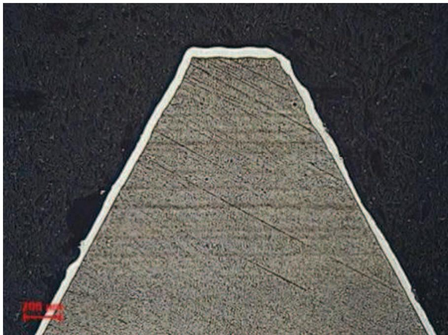
Figura 26: Espessura da camada de NiP com interdifusão a 600 °C. Aumento de 500x.
