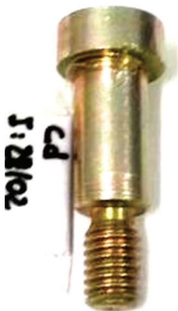
Figura 50: Parafuso temperado e revenido, revestido com cádmio. Após o ensaio de névoa salina
