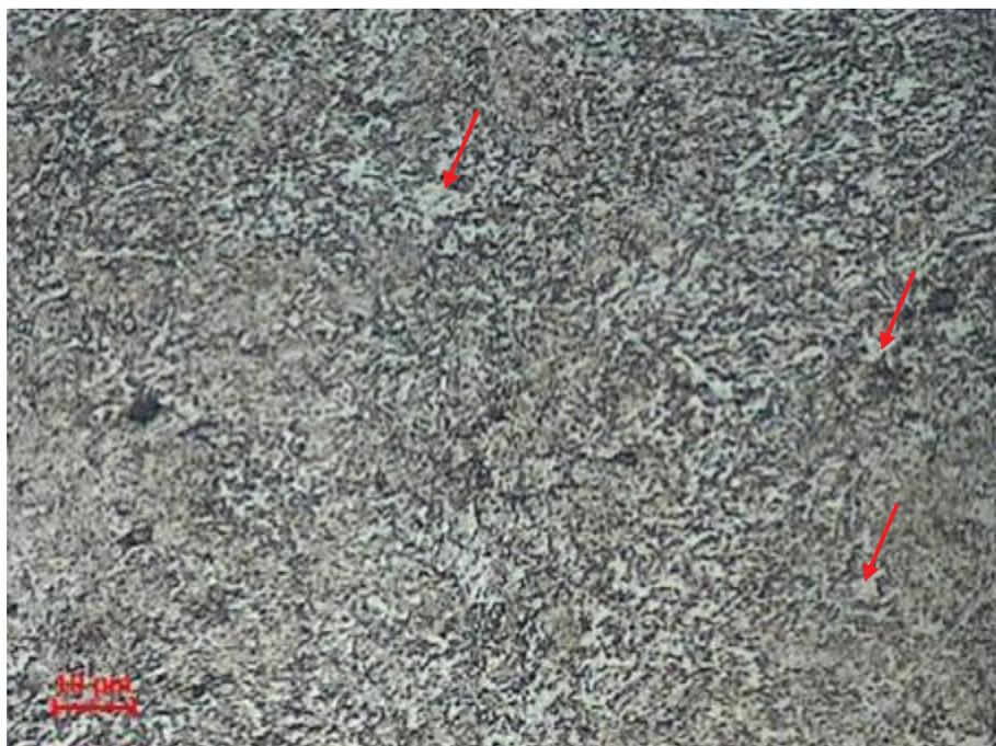
Na figura 22, temos a microestrutura resultante da amostra temperada e revenida. Na microscopia ótica, não foi evidenciada nenhuma diferença microestrutural entre as amostras que foram cadmiadas e aquelas que foram revestidas com NiP. Também não foi encontrada nenhuma diferença entre as amostras temperadas com e sem interdifusão, conforme pode ser visto nas figuras 22 a 24.
