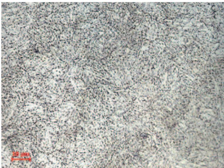
Figura 23: Microestrutura da amostra temperada e revenida com revestimento de NiP com interdifusão a 600°C. Aumento 1000X.
