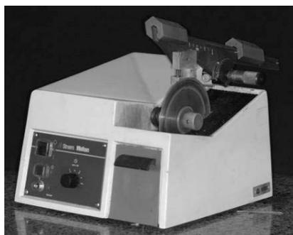
Figura 20 – Cortadeira metalográfica de precisão, seccionando um corpo de prova.
