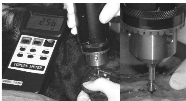
Figura 9 – Aferição do torque de inserção máximo de um dos MI (25,6 Ncm).
