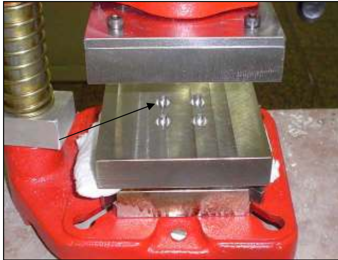
Figura 15 - Detalhe do molde em aço inoxidável, mostrando quatro metades que dão origem a duas cápsulas.
