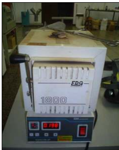
Figura 18 - Forno EDG® 1800 utilizado para recozimento.
