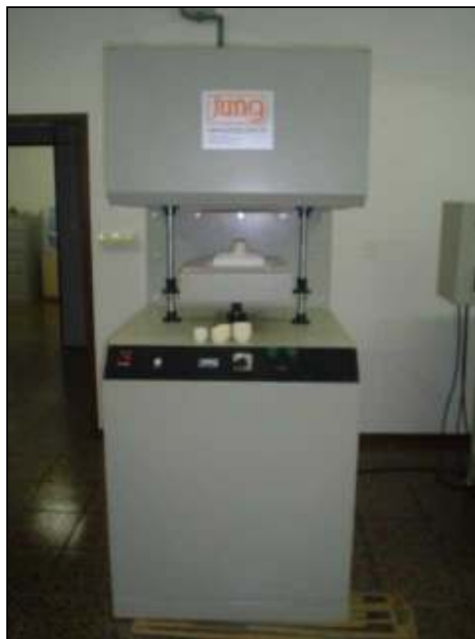
Figura 14 - Forno Jung® de 1600°C utilizado para fusão da matéria prima.
