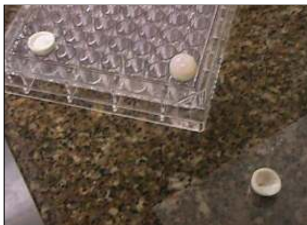
Figura 25 - À esquerda, metade da cápsula de Anortita preenchida com Prolopa ® HBS, no centro, cápsula de anortita vedada com silicone e à direita: metade da cápsula de anortita sem o fármaco.
