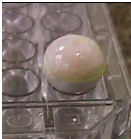
Figura 26 - Cápsula de Anortita vedada com silicone incolor.
