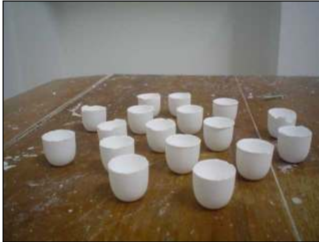
Figura 12 - Cadinhos de alumina para fusão do vidro.
