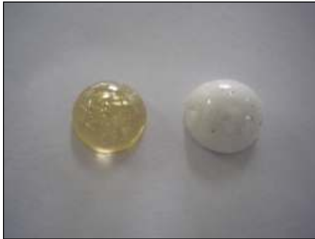
Figura 22 - Metades de cápsulas com acabamento. A matriz vítrea é mostrada à esquerda e à direita a cápsula que sofreu o processo de cristalização (vitrocerâmico Anortita).
