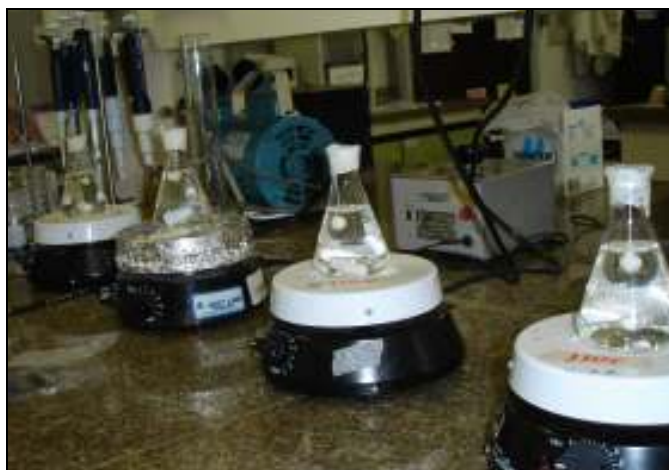
Figura 29 - Cápsulas de Anortita contendo Prolopa® HBS suspensas em solução tampão sob agitação constante.
