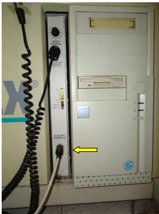
FIGURA 11: Cabo conectado na saída auxiliar do dinamômetro isocinético de onde foram obtidos os sinais de força isométrica voluntária máxima Fonte: A pesquisadora.
