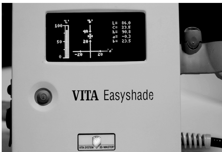
Fig.14 – Obtenção das coordenadas de cor através do sistema CIE L^* a^* b^*
