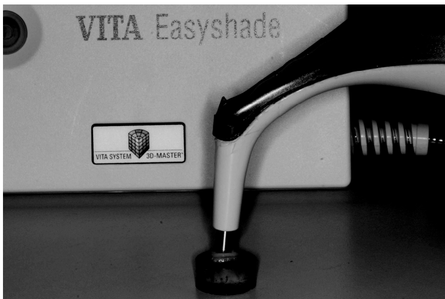
Fig.13 – Tomada de cor com colorímetro (VITA Easyshade, VITA, Bad Säckingen, Alemanha).
