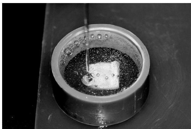
Fig.6 – Inserção de resina epóxi
