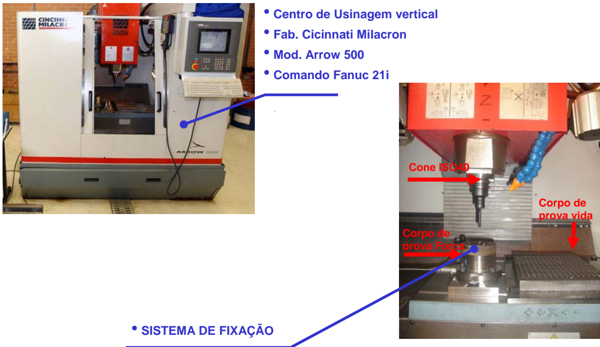
Figura 4.1: Centro de Usinagem e Sistema de Fixação da ferramenta e dos corpos de prova para ensaios de vida e Força.
