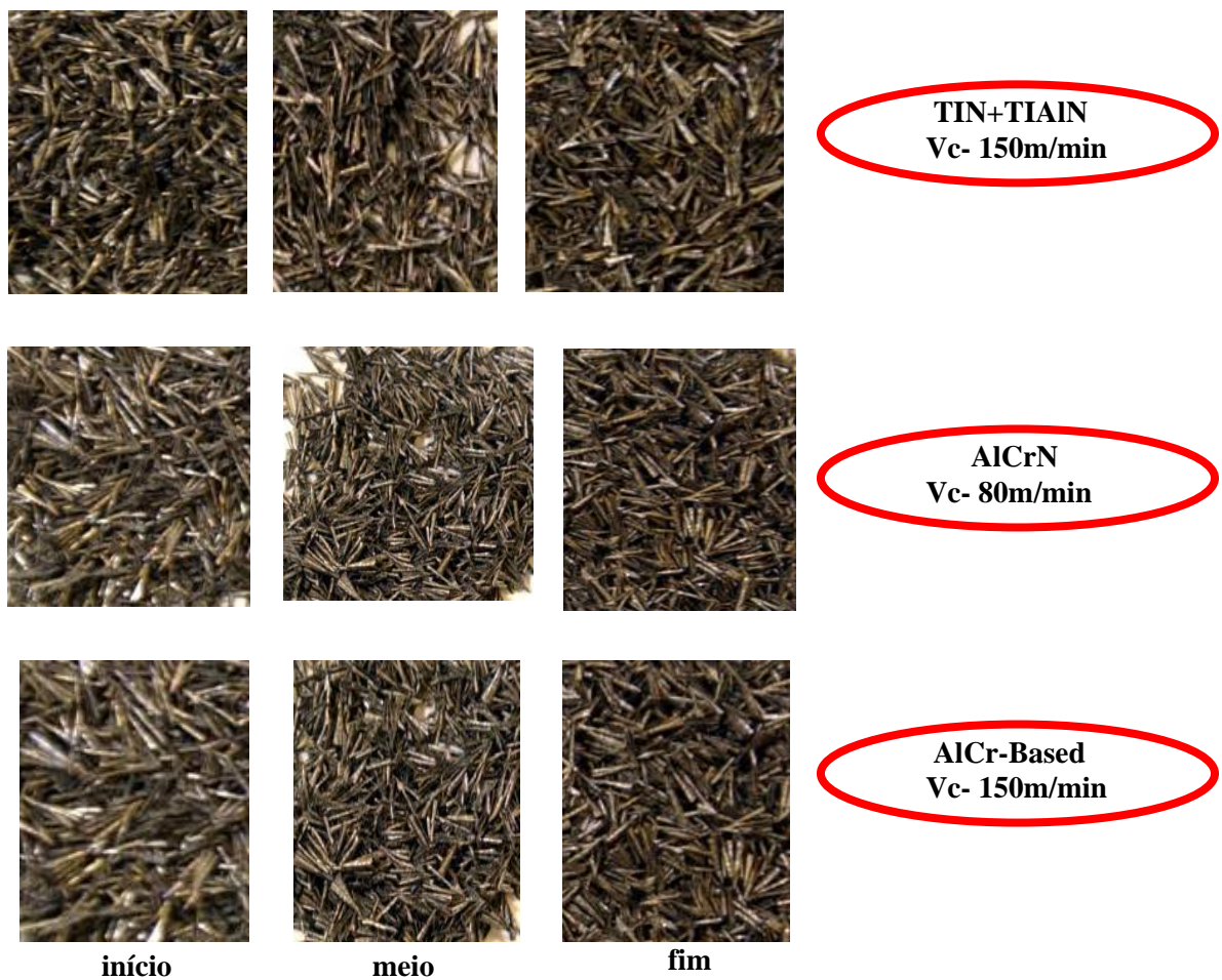
Figura 5.12: Análise da formação de cavacos nas condições de início e fim para os revestimentos ensaiados.
