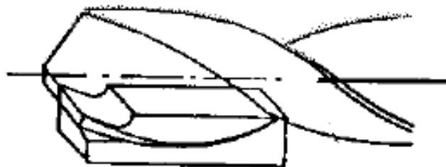
Figura 3.4: Caracterização entre uma broca helicoidal e uma ferramenta de Torneiar (Stemmer, 2001).
