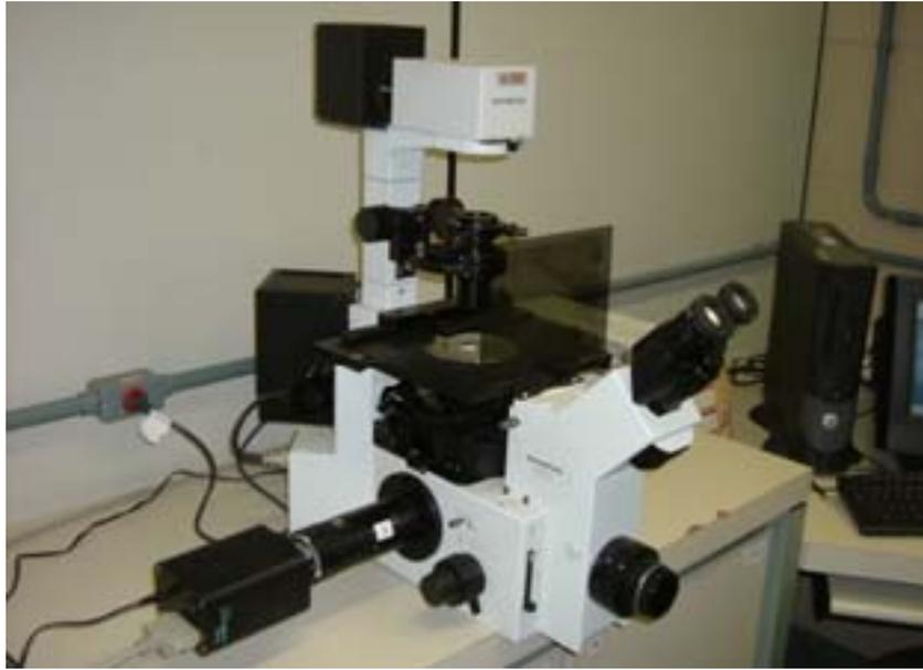
Figura 6 - Microscópio Óptico Olympus IX70®
