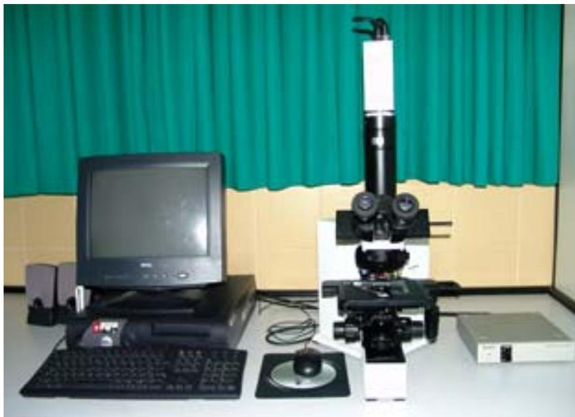
Figura 7 - Microscópio Óptico Olympus RX 50® com transdutor de imagem acoplado a um microcomputador
