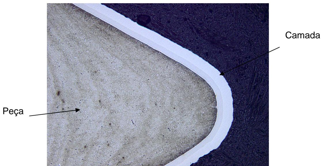
Figura 41 - Imagem da camada uniforme formada de Ni-P
