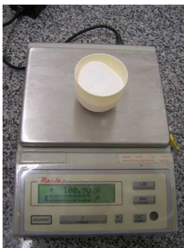
Figura 5. Mistura de pós em cadinho de alumina sobre balança (IGCB).
