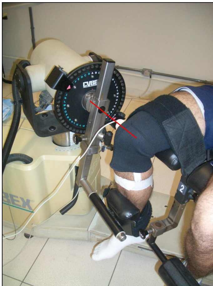
Figura 11 - Posicionamento e fixação do membro inferior a ser submetido ao teste do torque passivo. A linha em vermelho indica o alinhamento dos eixos biológico e mecânico.
