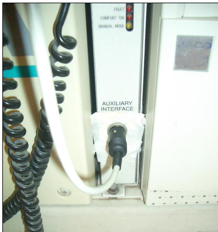
Figura 19 - Cabo conectado na saída auxiliar do dinamômetro isocinético de onde foram obtidos os sinais de torque.
