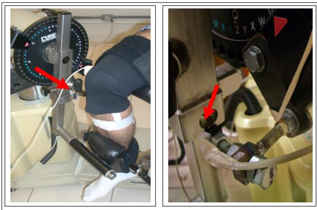
Figura 20 - Posição da chave em relação ao braço de alavanca antes do início do teste (seta vermelha - foto lado esquerdo) e a disposição da chave próxima do braço de alavanca do dinamômetro (seta vermelha – foto lado direito).
