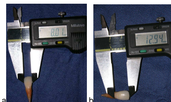
Fig. 1a e 1b. Medição da distância M-D e I-C dos dentes. (CD6 CS, Mitutoyo Coop, Kanagawa, Japão)
