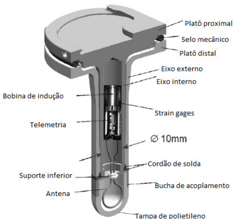
Figura 5 - Endoprótese Convencional de Joelho, componente tibial com instrumentação de telemetria. Fonte: Adaptado de HEINLEIN et al. , 2007.
