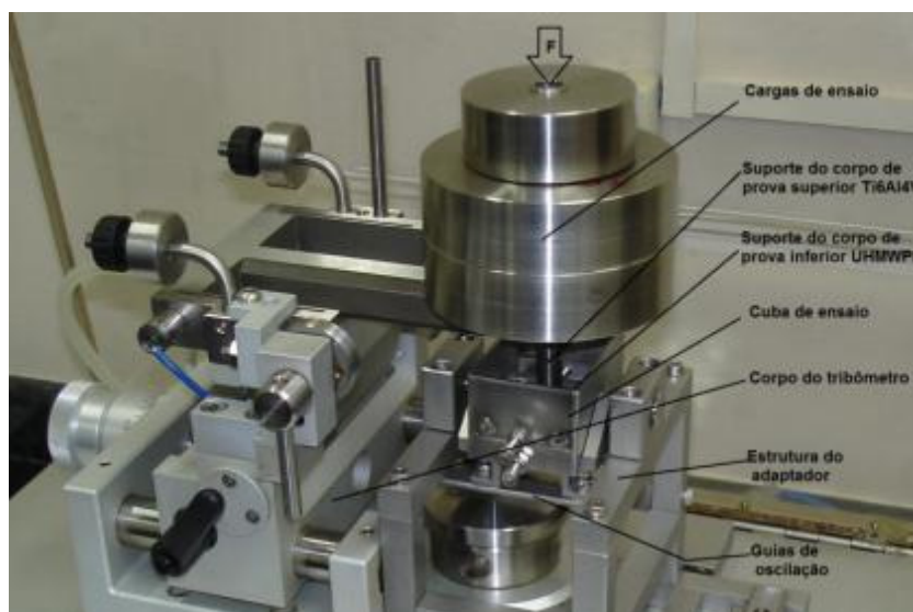
Figura 48 - Dispositivo montado e pronto para acionamento. Cargas de ensaio instaladas e corpos de prova posicionados para ensaio.
