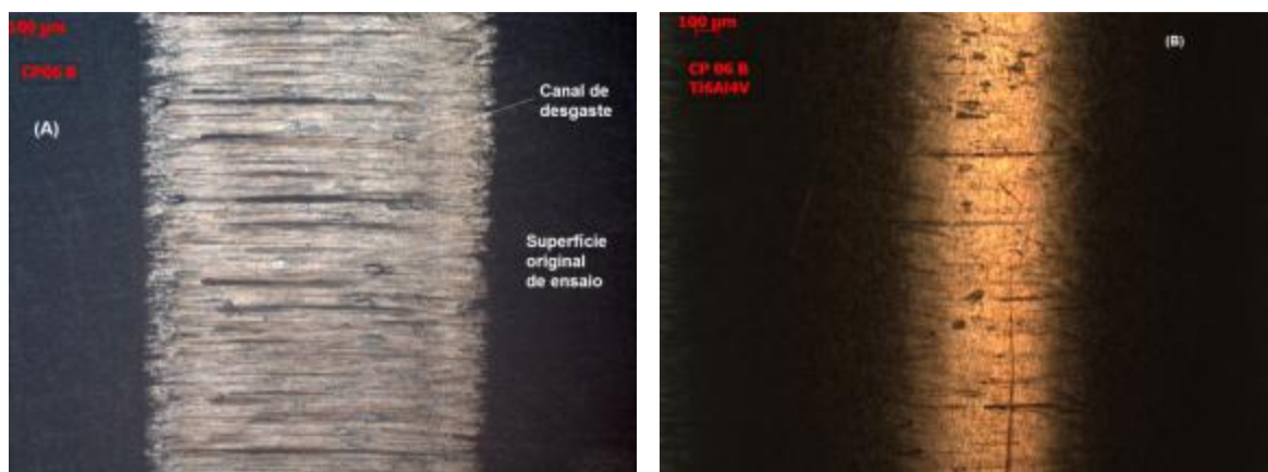
Figura 58 - Canal de desgaste no corpo de prova do ensaio 02. (A) Canal de desgaste ao longo da largura do corpo de prova de UHMWPE, 50 x. (B) Superfície de desgaste do corpo de prova de Ti6Al4V, 50 x.
