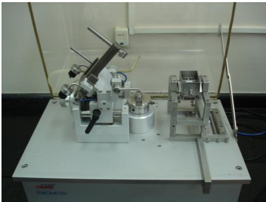
Figura 31 - Tribômetro após a remoção do módulo linear (esquerda) e dispositivo a ser acoplado (direita).
