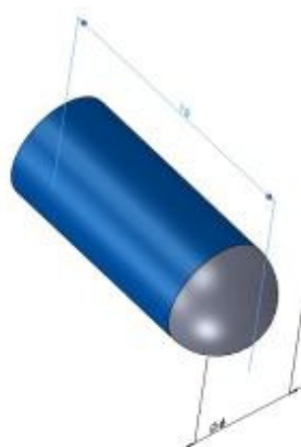
Figura 49 - Geometria e dimensões do pino de Ti6Al4V.
