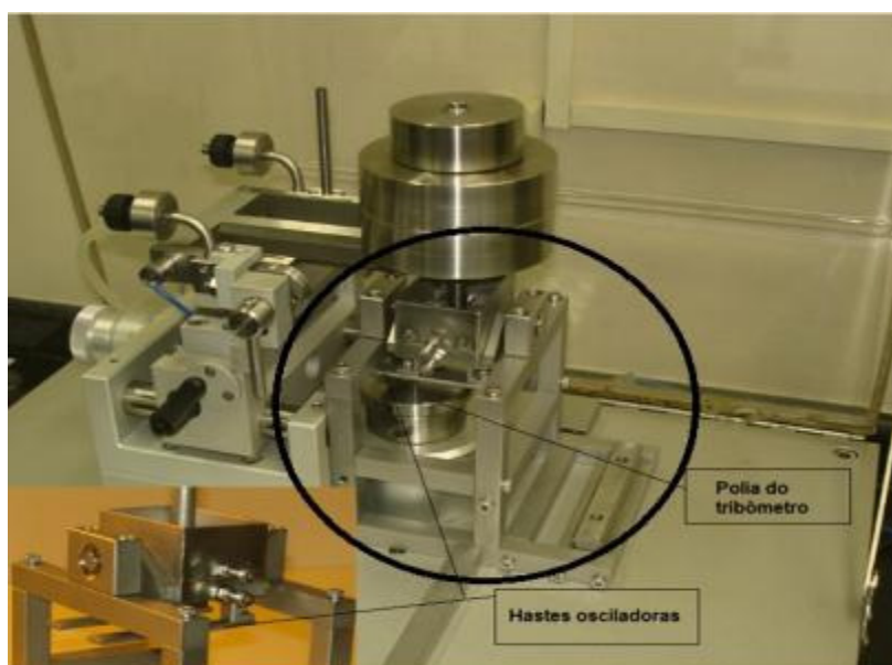
Figura 33 - Adaptador instalado (círculo) no tribômetro, no detalhe, as guias de oscilação na parte inferior do suporte da cuba.
