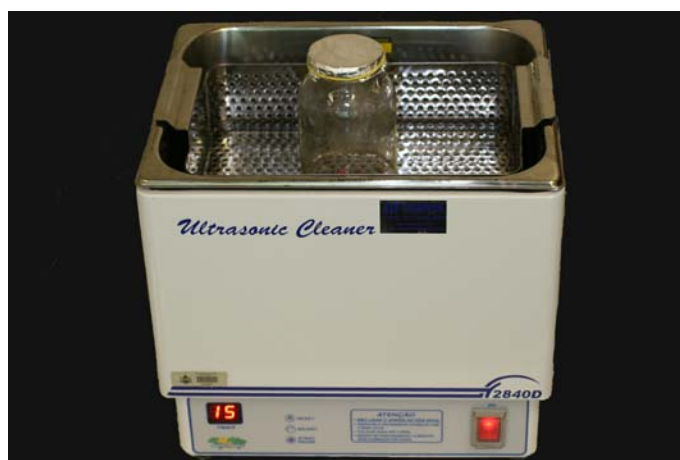
Figura 6. Frasco disposto no centro da cuba de ultra-som para remoção do biofilme.
