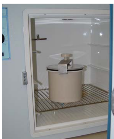
Figura 13. Armazenamento da jarra de anaerobiose em estufa a 37°C, por 72 horas.
