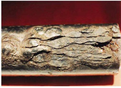
Figura 2.9 Corrosão por esfoliação. Fonte: [www.abraco.org](http://www.abraco.org)
