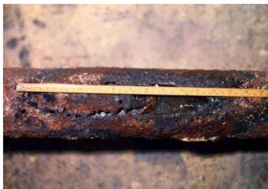
Figura 2.6 Corrosão Uniforme. Fonte: [www.abraco.org](http://www.abraco.org)
