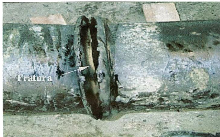
Figura 1.3 Seção do duto com fratura causada pela flambagem local da parede. (Cardoso, 2005).
