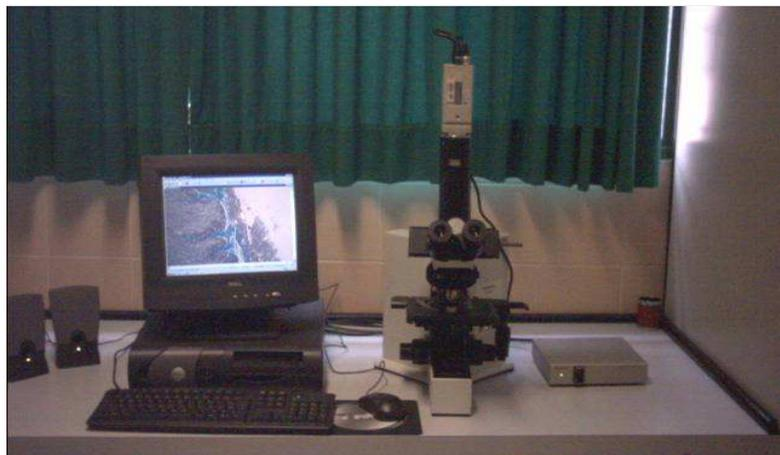
Figura 17. Microscópio Óptico Olympus BX50 associado ao tubo alongador Sony U-SPT e à câmera digital Sony CCD-Iris, acoplados ao computador. Sistema pertencente ao Laboratório de Patologia Experimental da PUCPR.
