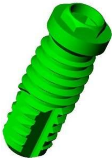
Figura 6. Implante modelado com 10 mm de comprimento.
