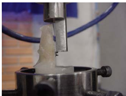
Figura 8: teste de cisalhamento
