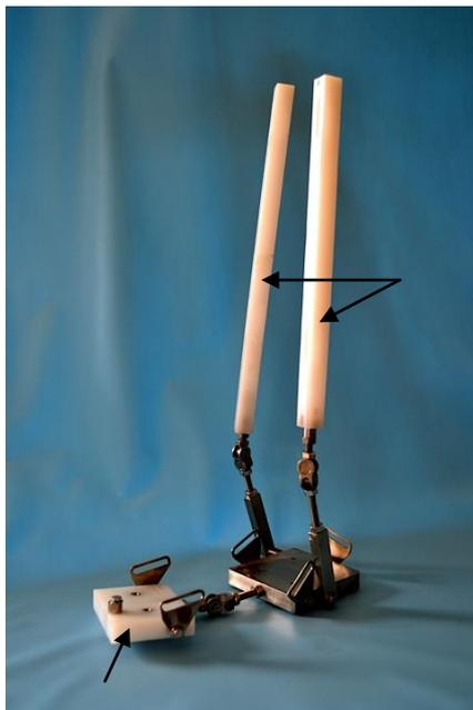
Figura 36 – Órtese confeccionada parcialmente em aço inox 316L e parcialmente em UHMWPE (parte anterior e as hastes acima das dobradiças - setas).
