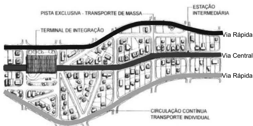
Figura 6 – Esquema do Sistema Trinário Fonte: IPPUC
