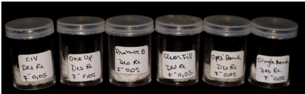
Figura 11. Recipientes plásticos com tampa contendo as lâminas imersas no diferentes meios de armazenamento.
