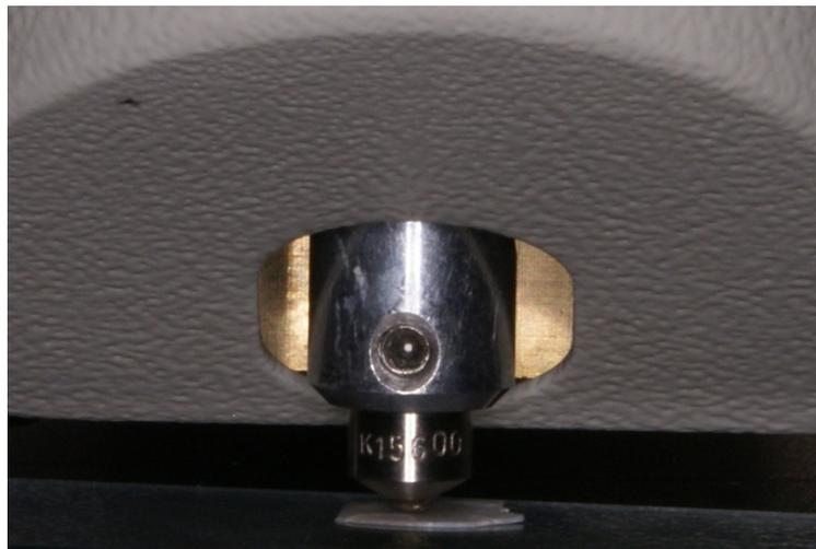
Figura 12. Teste de microdureza Knoop em microdurômetro HMV (Shimadzu).
