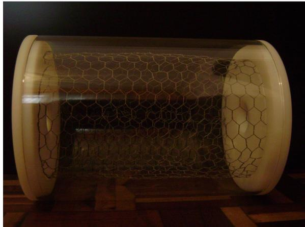
Figura 9.2 – Tela de contenção da lã de vidro no silenciador de câmara simples
