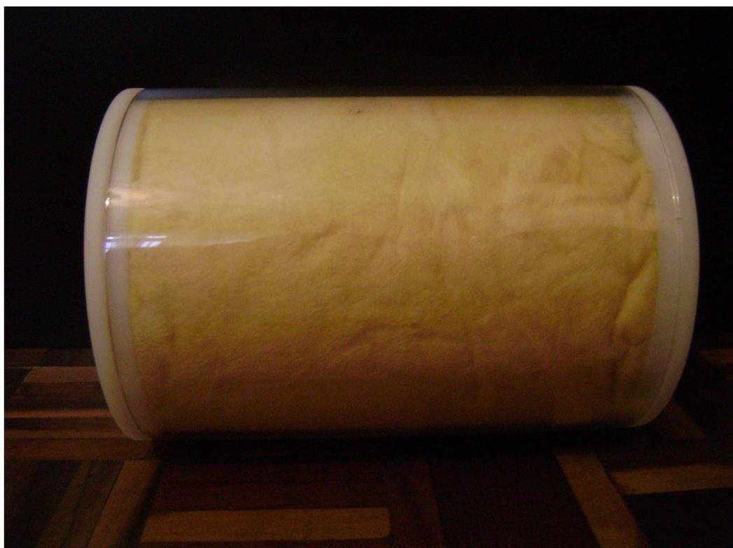
Figura 9.4 – Câmara do silenciador preenchida com material de absorção
