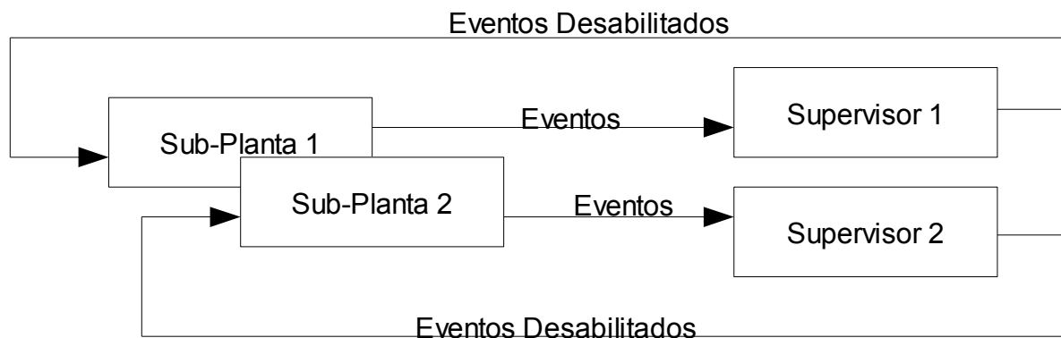
Figura 2.4 Funcionamento dos supervisores.
