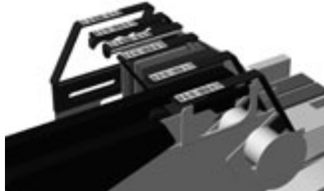
Figura 25: Alimentador com leitor de códigos de barras embutido
