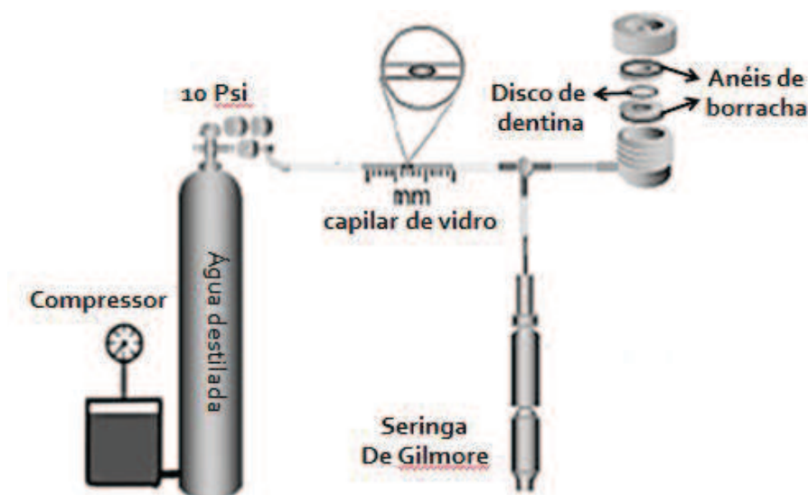
3 4 Figura 2: Desenho esquemático do sistema de filtração utilizado para mensurar a 5 condução hidráulica da dentina (Santiago et al., 2006). 6
