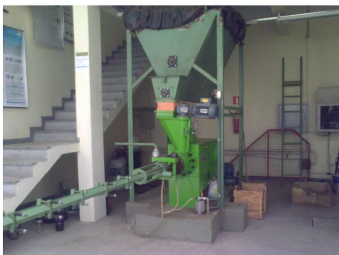
Figura 2 - "Briquetadeira" - unidade piloto do pólo de Ubá
