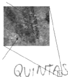
Figura 2.6 Imagem obtida por microscópio que mostra estrias produzidas por caneta esferográfica. Adaptado [JUSTINO, 2002].
