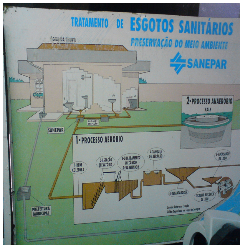
Figura 13 – Sistema de esgoto sanitário
