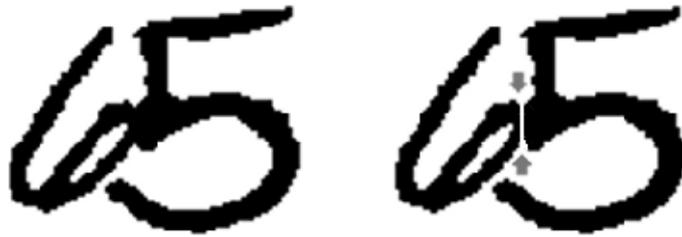
Figura 3.2: Na esquerda, exemplo de imagem da base de dados contendo os dígitos “65”. À direita a imagem depois de traçado seu “caminho ótimo de segmentação”.
