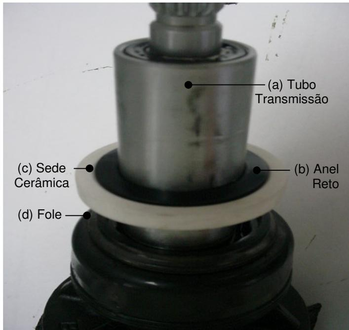
Figura 1.3 – Detalhe da vedação de um anel reto; a temperatura de serviço elevada acentua o efeito viscoelástico. (a) Tubo transmissão (material aço) responsável pelo movimento de centrifugação; (b) anel reto (material borracha nitrílica); (c) sede cerâmica (material alumina  $AL_2O_3$ ) e (d) fole (material composto de grafite).
