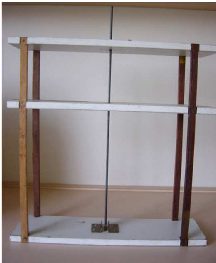
Figura 8 – Aparelho utilizado para confecção das fraturas padronizadas no fêmur dos ratos
