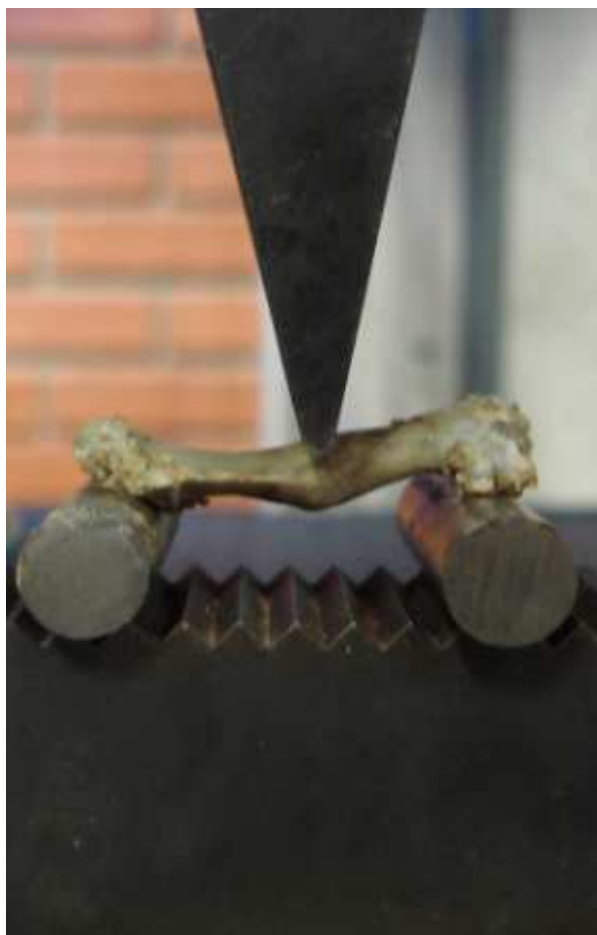
Figura 13 – Ensaio mecânico de três pontos no calo ósseo do fêmur do rato. Notar os apoios laterais para suporte do osso e o cutelo atuando no calo ósseo do fêmur
