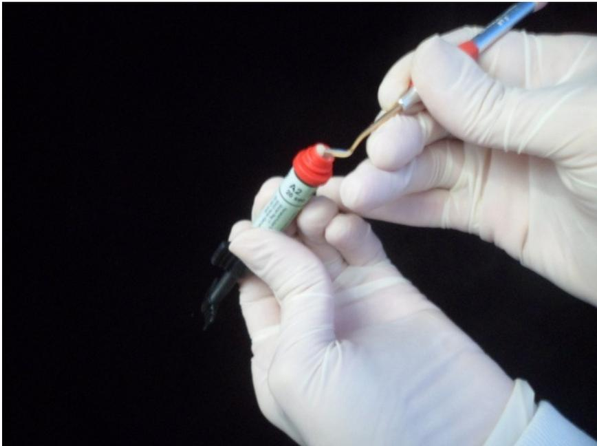
Figura 8 - Remoção da esfera da resina composta da bsnaga para ser levada ao pedestal do aparelho (Acuvol Acuvol, BISCO Inc., Schaumburg, IL, EUA).
