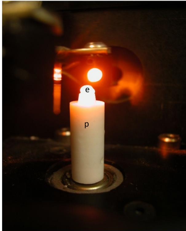
Figura 9 – Pedestal (P) no interior do equipamento para medida da contração volumétrica (Acuvol, BISCO Inc., Schaumburg, IL, EUA) com a esfera (e) de resina composta inserida.
