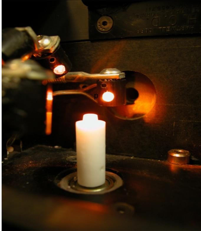
Figura 7 – Pedestal (P) para inserção da esfera de resina composta no interior do equipamento para medida da contração volumétrica (Acuvol, BISCO Inc., Schaumburg, IL, EUA).
