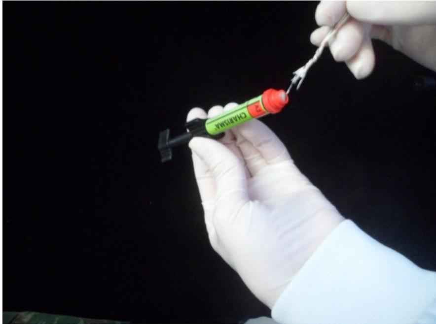
Figura 5 – Aferição da temperatura da resina composta com o termopar do multímetro digital.
