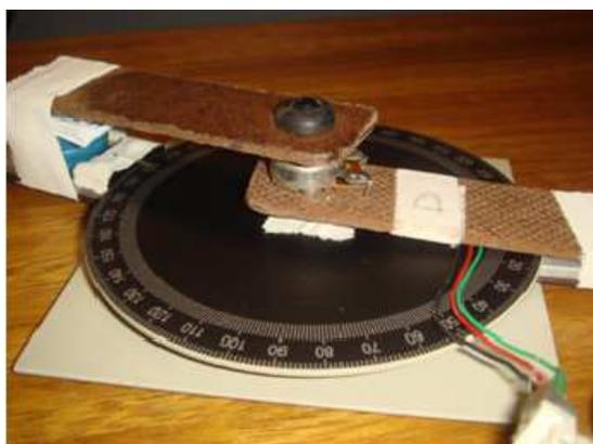
Figura 28: Eletrogoniômetro fixado no compasso de precisão para o procedimento de calibração.
