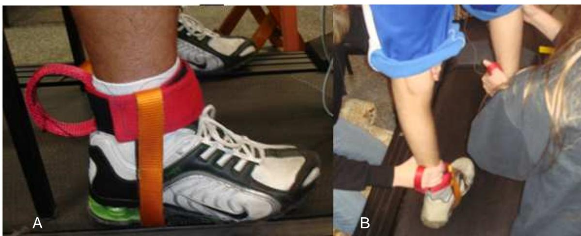
Figura 25: Tornozeleira posicionada no pé do voluntário (A) permite segurar firmemente o pé e facilita a movimentação do mesmo durante o TLSP (B).
