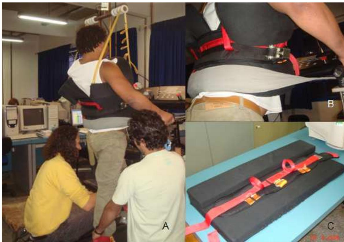
Figura 58: Colete desenvolvido posicionado em um dos voluntários do estudo (A) durante a aplicação do TLSP. Também é possível observar a faixa extra com sistema de catraca para fixar melhor o colete junto ao corpo (B) e o mesmo desmontado (C).
