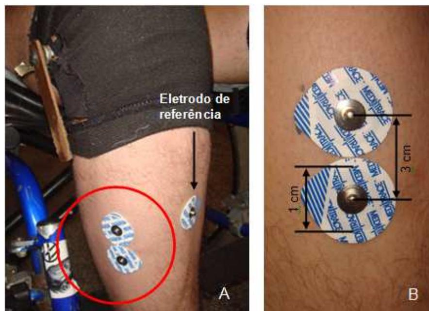
Figura 51: Posicionamento do eletrodo de referência no terço médio da tíbia (A), também está representada uma ampliação da região destacada (B) mostrando a distância entre os eletrodos.
