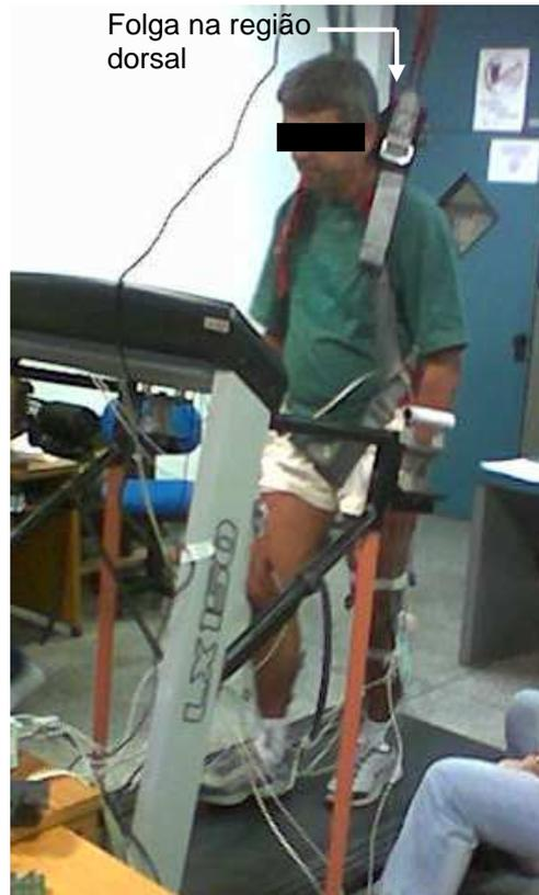
Figura 57: Teste do colete Altiseg modelo Amazonas com o indivíduo hígido, pode ser observada a manutenção da posição ortostática. No entanto, persistiu o desconforto na região inguinal e não foi possível um adequado uso do colete ao indivíduo ficando folgas principalmente na região dorsal.
