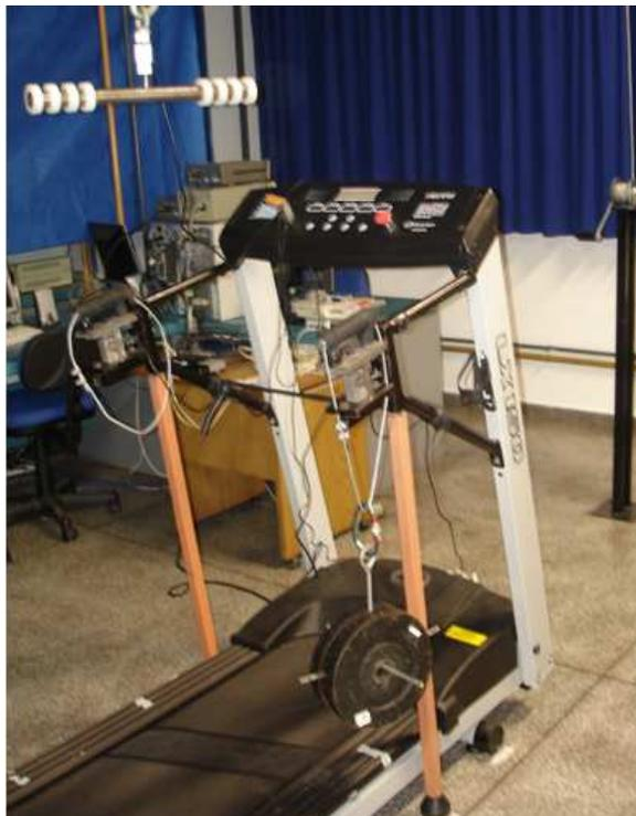
Figura 22: Procedimento de calibração da célula de carga da mão direita, onde foi sendo acrescido e depois decrescido anilhas de 5 e 10 kg.
