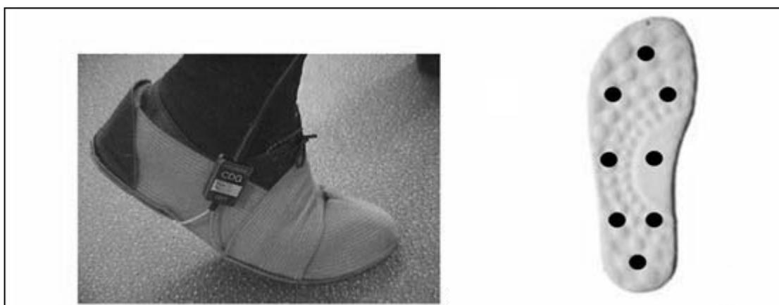
Figura 5: Sensores posicionados na palmilha do sapato para identificar as fases da passada (LINDQUIST, 2005).
