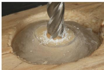
Início do desgaste da fresa de 5mm;
