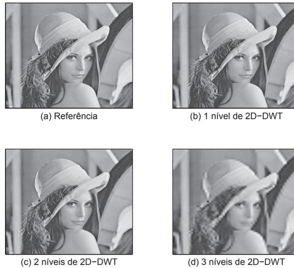
**Figura 35:** Três níveis de 2D-DWT aplicados à imagem *Lena* monocromática de tamanho 512x512 *pixels*. (a) Imagem de referência. (b) 1 nível de 2D-DWT. (c) 2 níveis de 2D-DWT. (d) 3 níveis de 2D-DWT.
