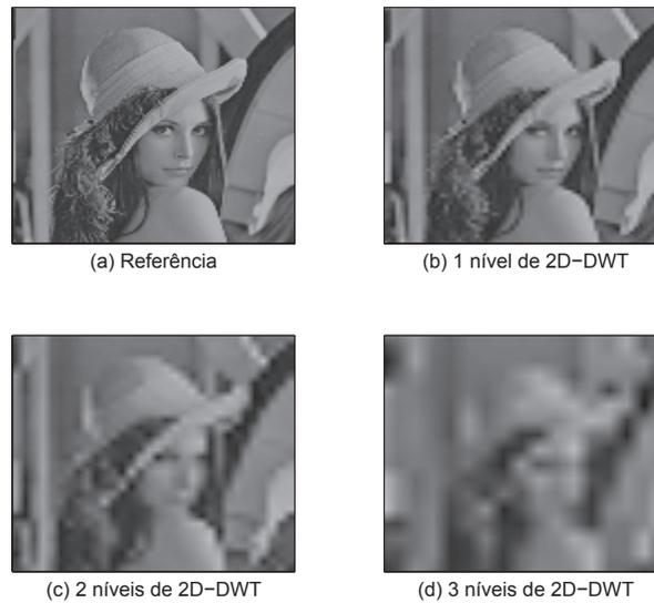
**Figura 37:** Três níveis de 2D-DWT aplicados à imagem *Lena* monocromática de tamanho  $128 \times 128$  pixels. (a) Imagem de referência. (b) 1 nível de 2D-DWT. (c) 2 níveis de 2D-DWT. (d) 3 níveis de 2D-DWT.
