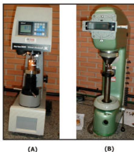
Figura 54 Durômetros utilizados nos ensaios de dureza.
