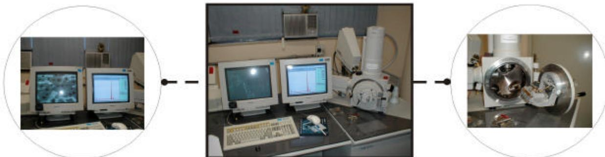
Figura 59 Microscópio eletrônico de varedura Philips XL20
