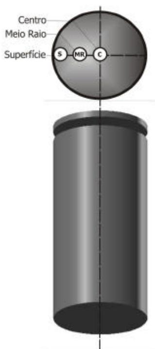
Figura 49 Representação esquemática das posições analisadas.
