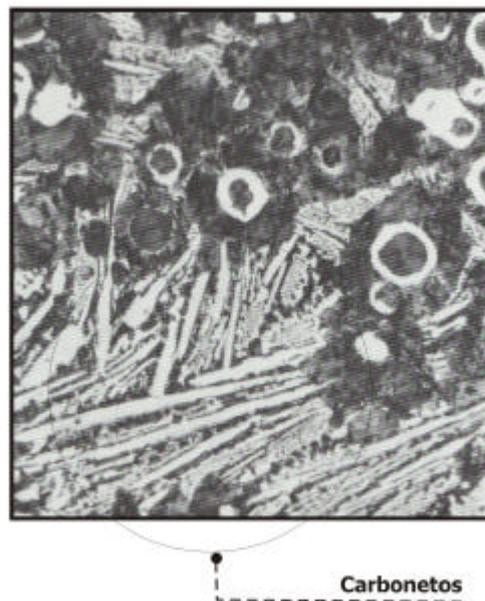
Figura 33 Coquilhamento inverso devido a inoculação deficiente 250x – Picral. [4]
