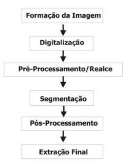
Figura 43 Típica seqüência de processamento e análise de imagem. [46]
