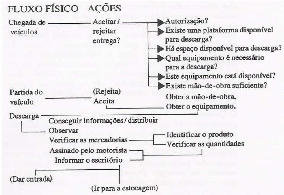
Figura 15: Recebimento de materiais: diagrama de fluxo de informações. Fonte: Moura, 1997.
