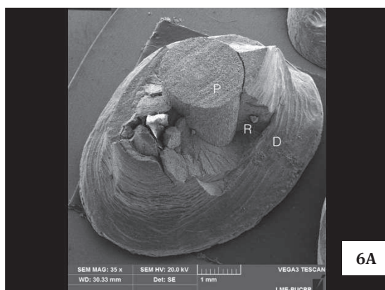
Figura 6-A: Grupo DZ com fratura tipo III, com deslocamento e fratura do núcleo de preenchimento em resina composta fotoativada (R) com exposição do pino (P) (40x) ; Figura 6-B: Mesmo espécime demonstrando exposição do pino (P), mas sem danos ao remanescente dental (D) em área de fêrula (100x).
