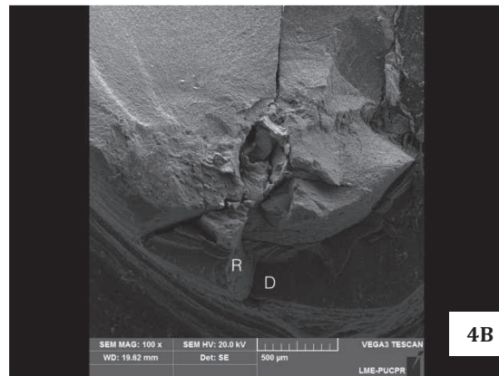
Figura 4-A: Fratura tipo III em um espécime do Grupo Z com deslocamento de mais de 50% da resina composta (R) (40x); Figura 4-B: Visualização da fratura da resina composta, com manutenção da integridade do dente (D) (100x).
