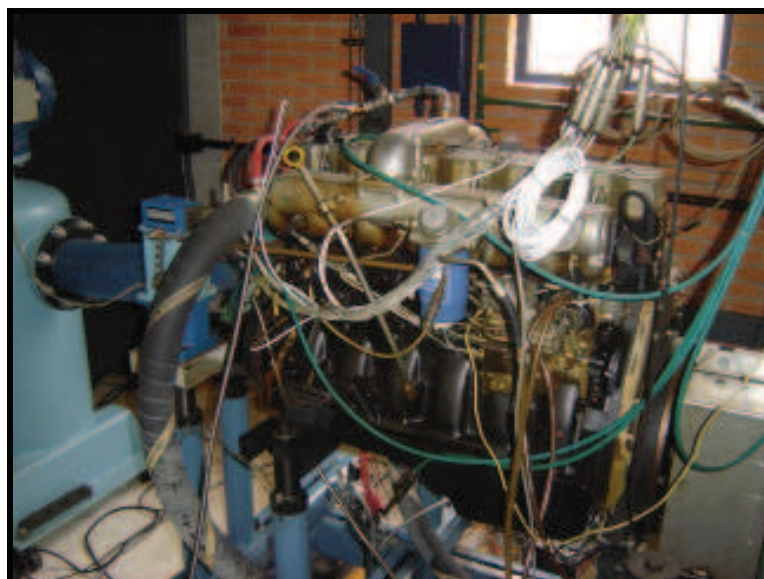
Figura 17 – Motor convertido para funcionamento DG – visão geral.
