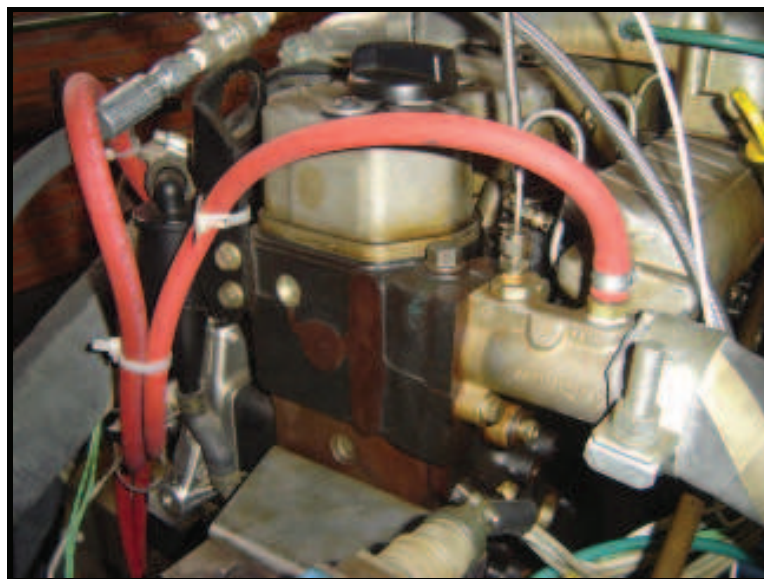
Figura 39 – Tomada de temperatura na saída da água de arrefecimento.
