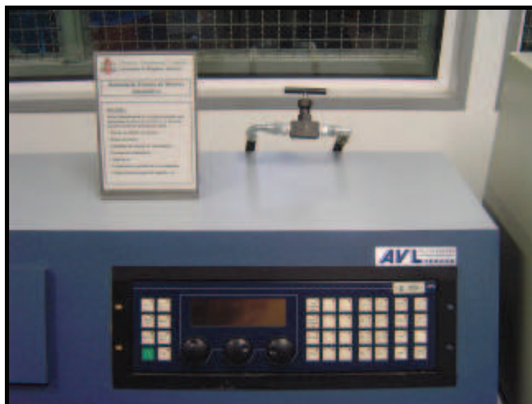
Figura 19 – Painele de controle do dinamômetro.
