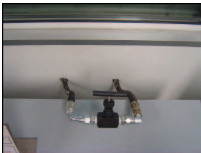
Figura 09 – Válvula de ajuste de vazão de GNV.
