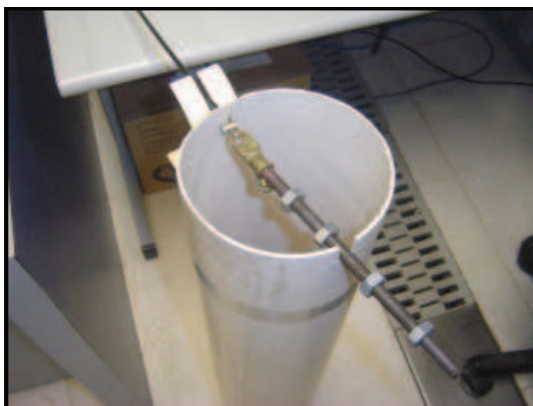
Figura 14 – Sistema de controle manual para dosagem de diesel.
