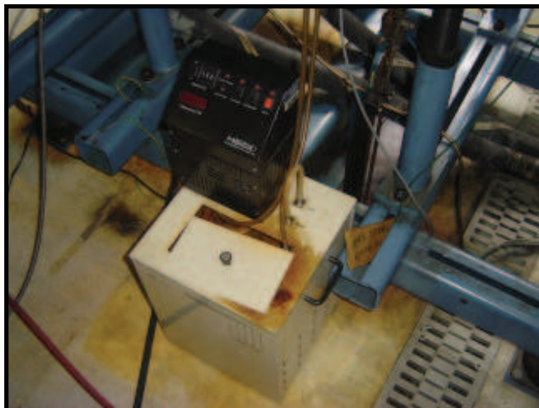
Figura 23 – Condicionamento de temperatura do diesel.
