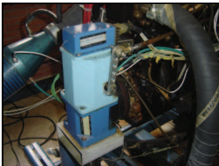
Figura 13 – Sistema de aceleração automatizado do dinamômetro.
