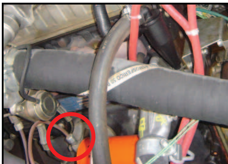
Figura 40 – Tomada de pressão da galeria de óleo lubrificante.
