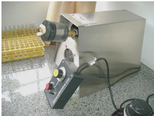
**Figura 8.** Rompedor de células tipo *beadbeater* utilizado para o pre-tratamento na extração de DNA de esporos de *Nosema* spp.
