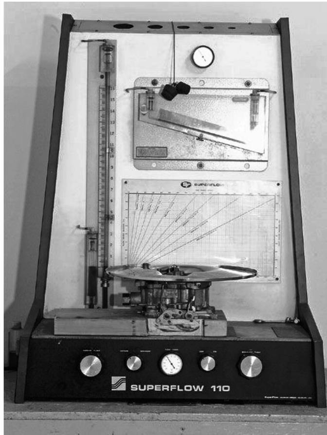
Figura 38: Vista geral da bancada de fluxo *Superflow 110*. Os indicadores de pressão são manômetros de coluna hidrostática, a peça sob ensaio está montada sobre uma superfície horizontal logo acima dos botões de controle.
