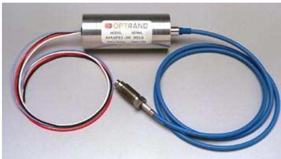
Figura 28: Vista do sensor de pressão, (Wlodarczyk, 1999)
