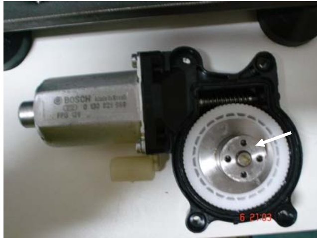
Figura 21: Motor mostrando a engrenagem usinada, indicada pela flecha.
