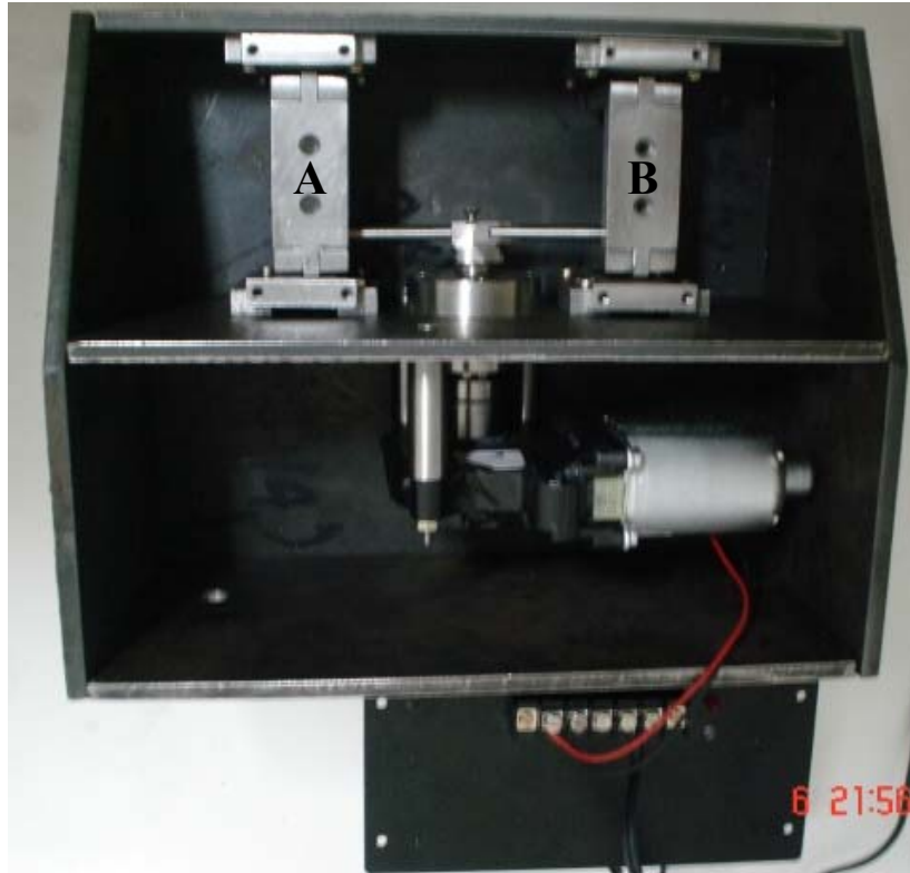
Figura 34: Equipamento montado em vista superior, mostrando o posicionamento do motor e a instalação do transformador.
