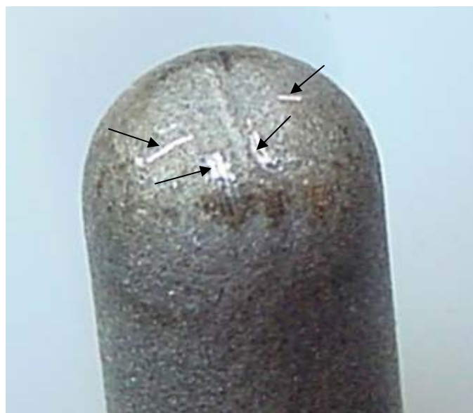
Figura 38: Superfície do pino em Cr-Co-Mo após o término do ensaio e limpeza da peça, mostrando riscos na superfície que manteve contato com o polietileno (setas).
