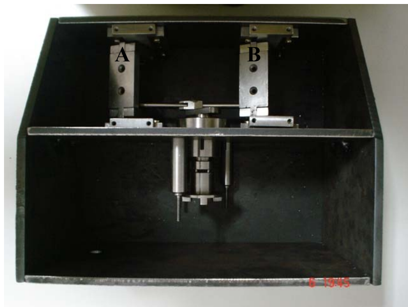
Figura 33: Equipamento em vista superior, mostrando o posicionamento dos basculantes (A e B) e do eixo para o motor.
