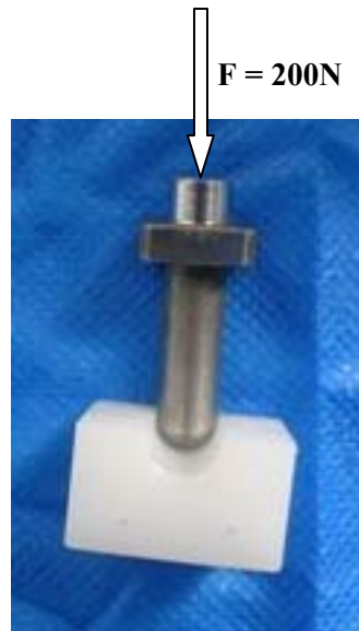
Figura 18: Ilustração da direção da força aplicada sobre os componentes protéticos durante o ensaio. A flecha corresponde ao sentido da força.
