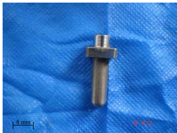
Figura 14: Pino microfundido em Cr-Co-Mo, fabricado para o ensaio.
