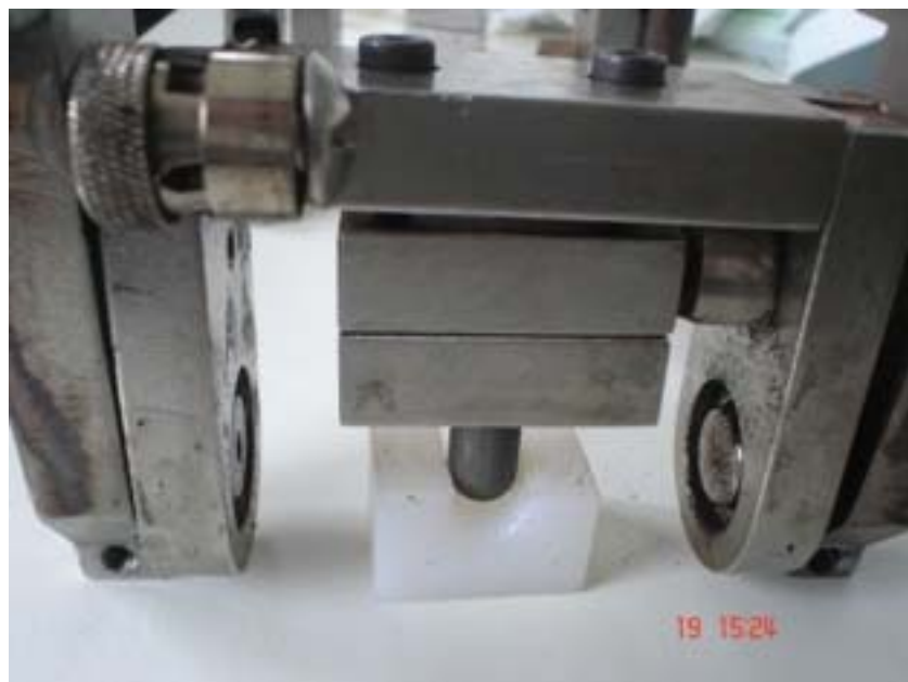
Figura 29: Basculante mostrando o acoplamento do pino e posicionamento da fossa.
