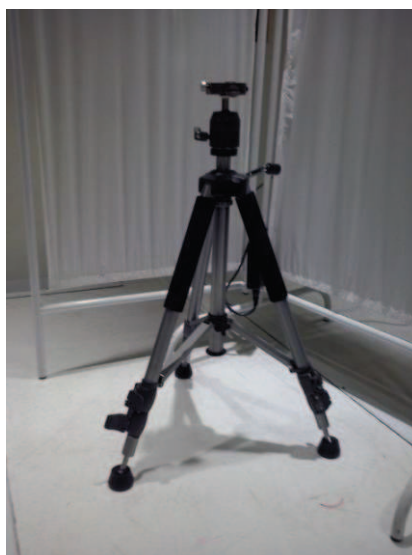
Figura 22: Suporte para a câmera termográfica
