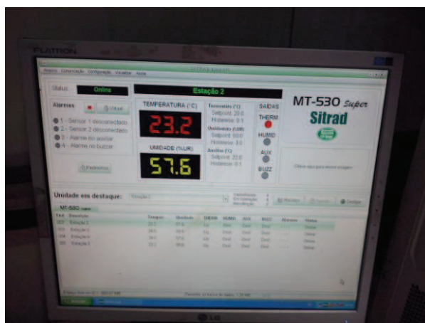
Figura 24: Monitoramento da temperatura e umidade da sala de termografia Fonte: A autora, 2014
