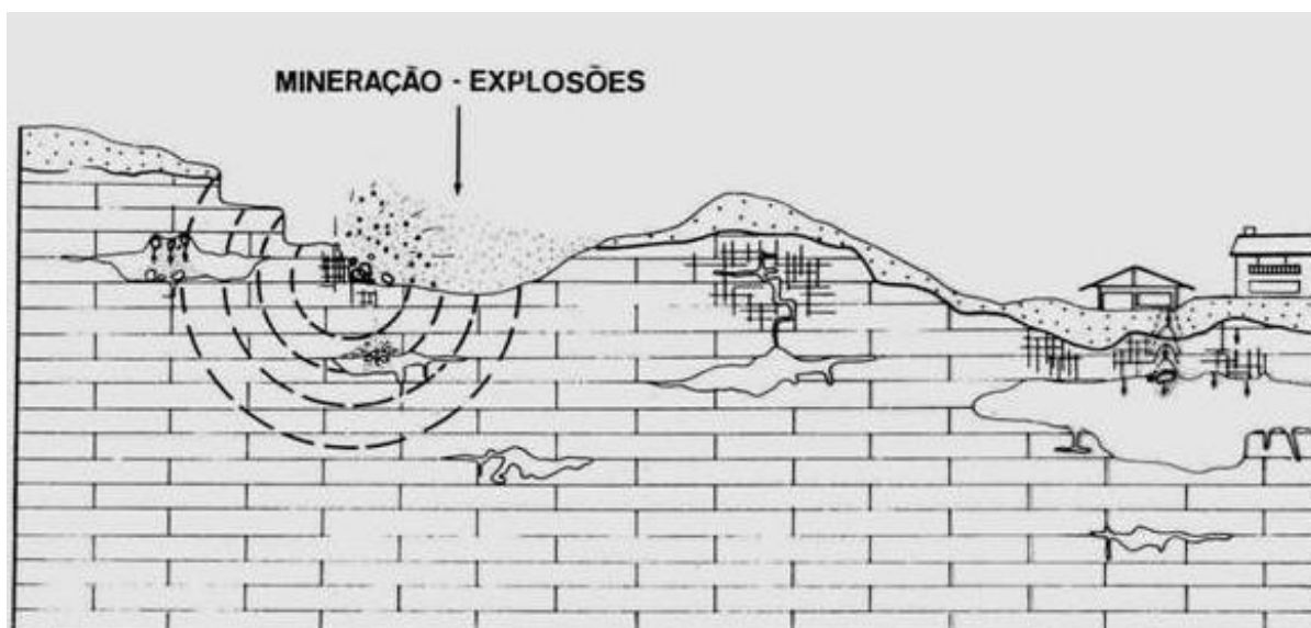
FIGURA 2.19 – AFUNDAMENTOS ASSOCIADOS A VIBRAÇÕES CAUSADAS PELO USO DE EXPLOSIVOS EM PEDREIRAS FONTE: Oliveira (1997, p. 18)
