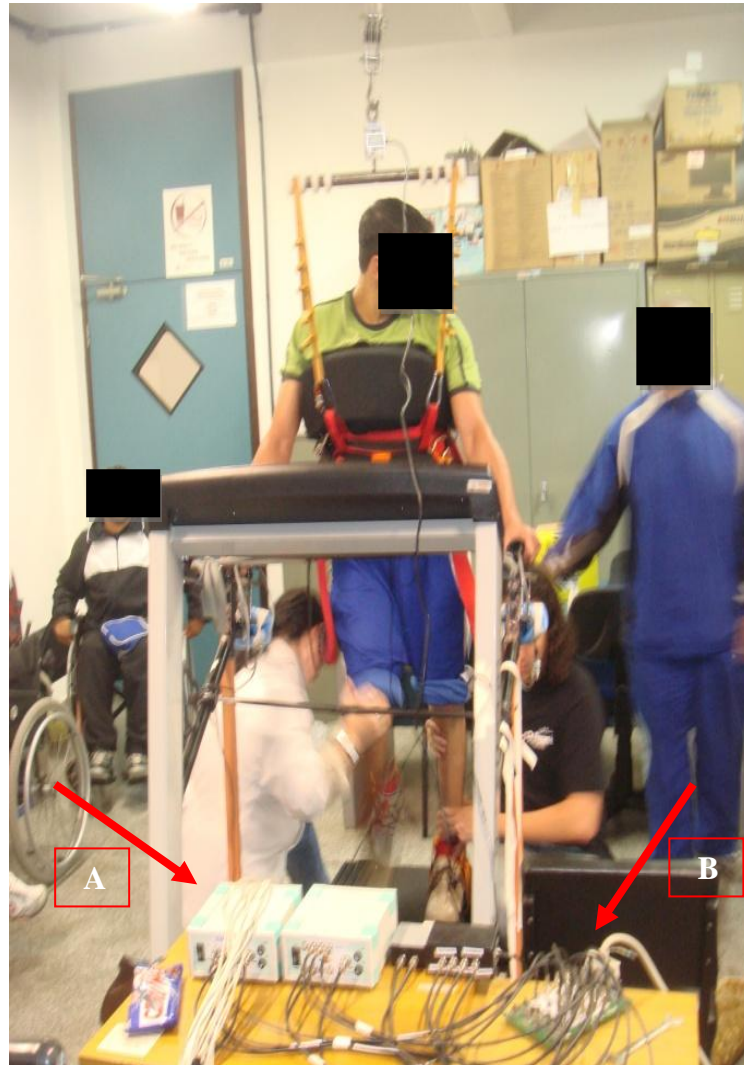
Figura 29 – A: Placa de aquisição PCI 6024E ( National Instruments ) com frequência de amostragem de 1000 Hz. B: Placa modelo SCB-68 ( National Instruments ), com uma frequência de amostragem de 1000 Hz para cada canal.
